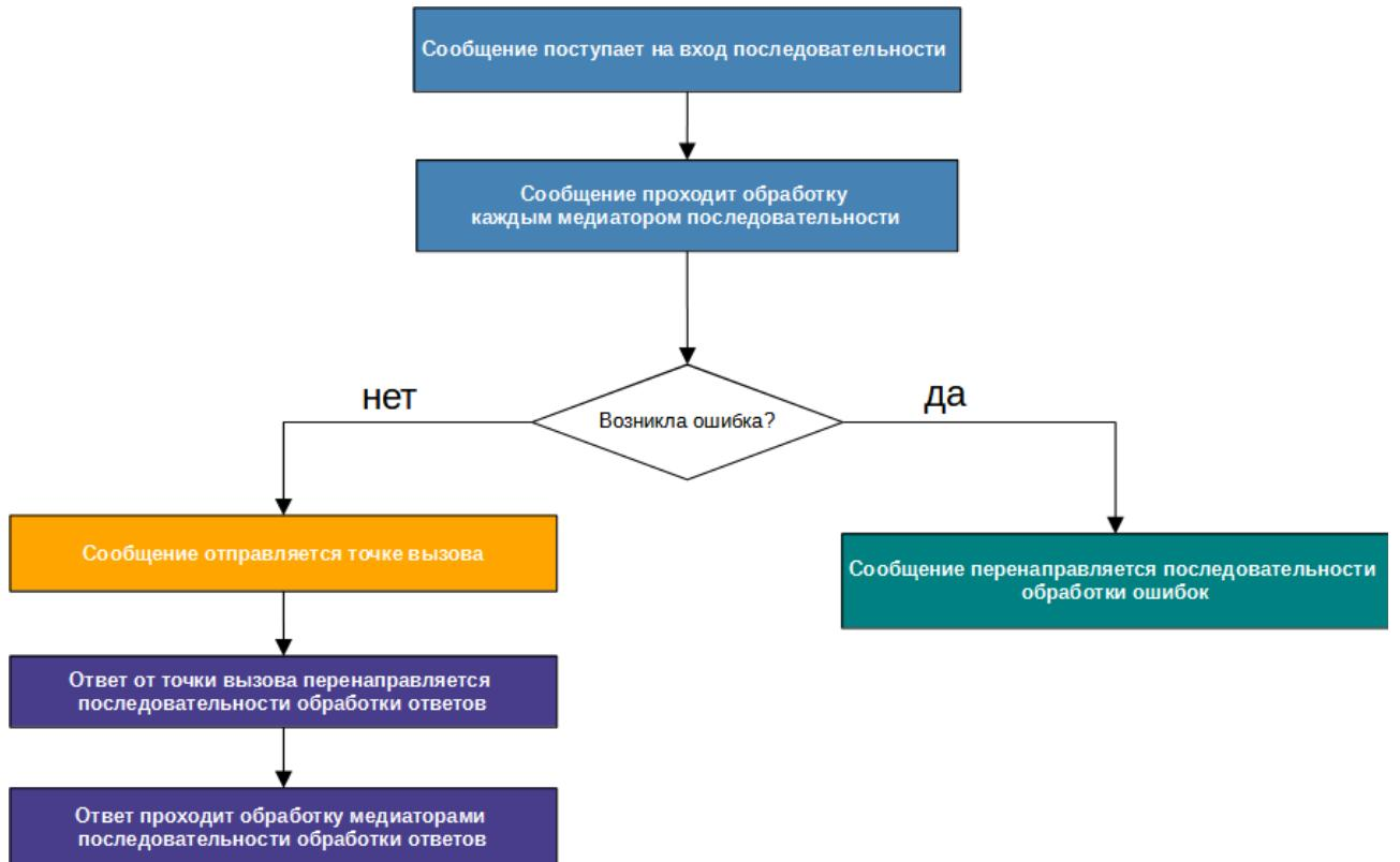
**Рис.3. Обработка сообщения: запрос, ответ и последовательность ошибок**
